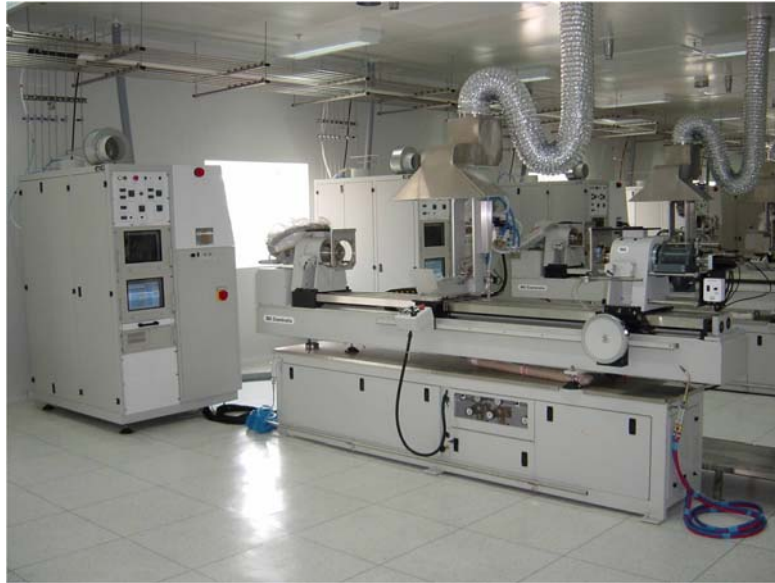
Equipamiento para MCVD en las instalaciones de Fibercore (Cambridge, UK)
