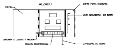
INSTALACIÓN DE TOMA DE TIERRA EN UN CUADRO ELECTRICO CON REGLETA POTENCIA > 60 cv. (116 A.)
