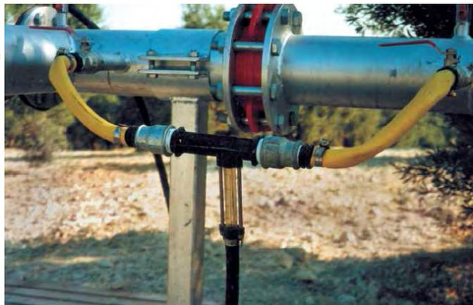
Dispositivo Venturi para inyectar la solución nutritiva al agua de riego
