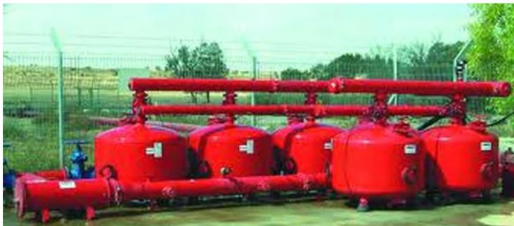
Figura . Batería de filtros de arena.
