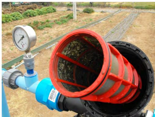
Figura. Manómetro después de un filtro de malla para medir la pérdida de carga.
