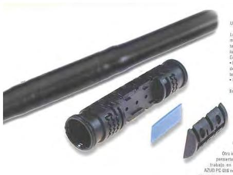
Figura . Despiece de un gotero integrado autocompensante. En el centro, la membrana elástica que produce el efecto de autocompensación
