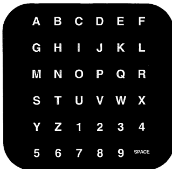
Figura 2.2: Matriz de letras formada por 6 filas y 6 columnas de letras que se van iluminando aleatoriamente
