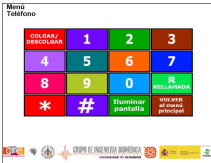
Figura 5.6: Submenú de control del teléfono. El usuario puede seleccionar varios comandos de control del mismo: colgar o descolgar, marcar un dígito del 0 al 9, usar la tecla de rellamada, etc., así como volver de nuevo al menú principal.
