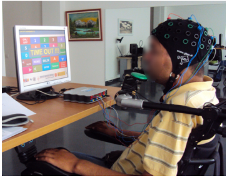
Figura 5.8: Un usuario del CRE, participante en el estudio, realiza pruebas con la aplicación BCI de control domótico desarrollada durante el presente proyecto. En la fotografía se puede observar el montaje de electrodos necesario para el registro de la actividad EEG, así como el amplificador de señales biomédicas, que destaca por su pequeño tamaño.
