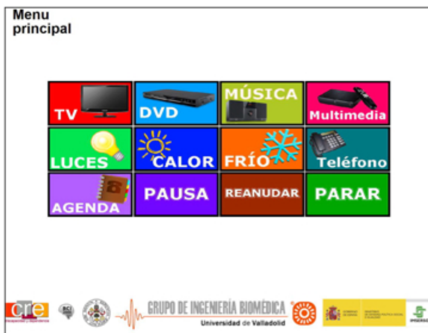
Figura 5.5: Menú principal de la aplicación BCI de control domótico. El usuario puede acceder desde el menú principal a los diferentes dispositivos que controla la aplicación: TV, DVD, equipo de música, disco multimedia, teléfono, agenda, ventilador, calefactor y luces.
