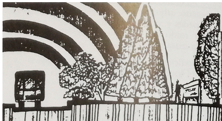
Fig. 4.10 Para el control acústico en el espacio urbano, las masas vegetales se presentan como una buena solución, sobre todo en torno a las vías de intenso tráfico. Véase anexo 1.
