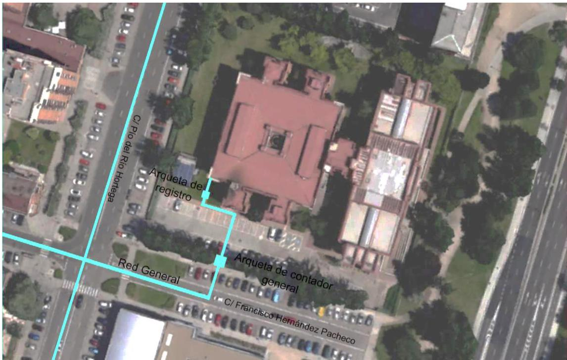
Figura 6o. Planta de situación. Red general de suministro Fuente: CASADO DE PAZ, Pablo. TFG: Optimización del grupo de presión de la ETS arquitectura de Valladolid a partir del estudio de la instalación de AFS
