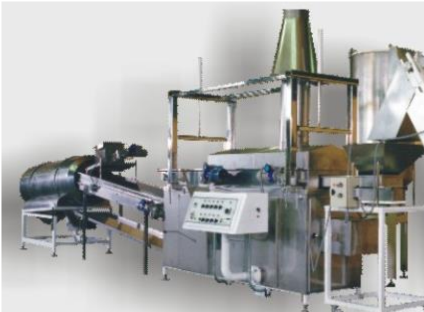
Figura 1. Línea de fritura de pellets en continuo. Fuente: Empresa suministradora de maquinaria
