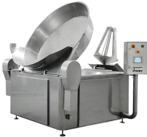
Figura 2. Línea de fritura de pellets en discontinuo. Fuente: Empresa suministradora de maquinaria
