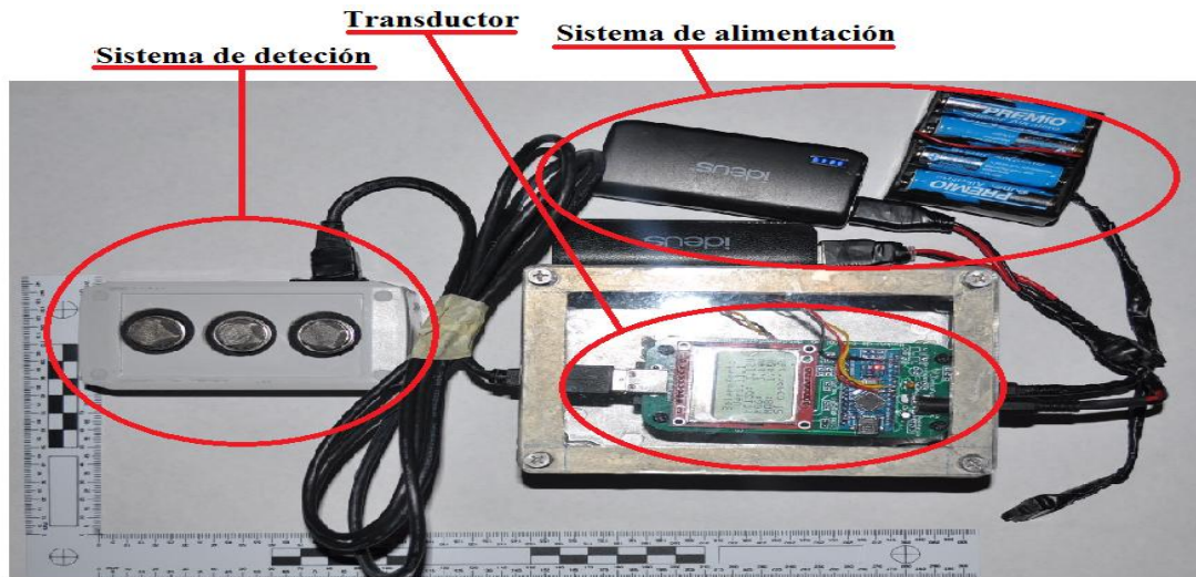
Figura 43: Conjunto del equipo de detección Belerofonte II y sus componentes
