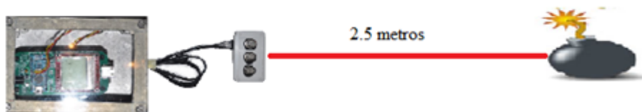
Figura 24 representación de la situación del equipo de detección al origen de la explosión durante las pruebas post-explosión.
