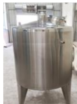
Imagen 3. Ejemplo de tanque mezclador con camisa calefactable
