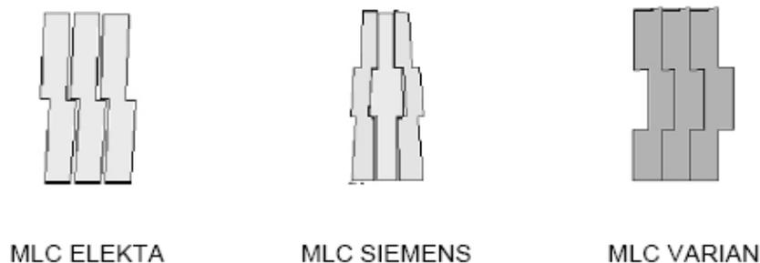
**Figura 2.8.** Vista de la unión lateral para los tres tipos de MLC.
