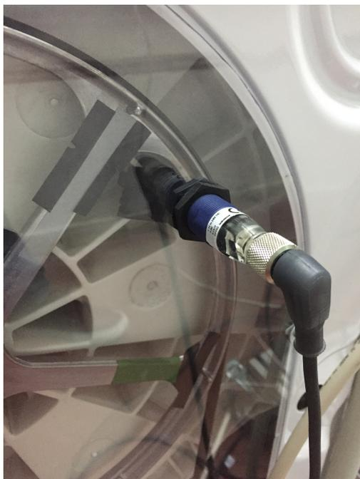
Imagen 4. Instalación fotoeléctrico
