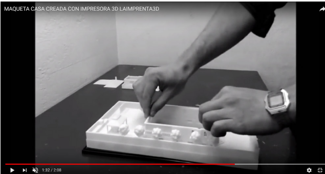
Video demostrativo con pequeña maqueta realizada con impresión 3d en varias partes para salvar las limitaciones de tamaño de las impresoras estándar
