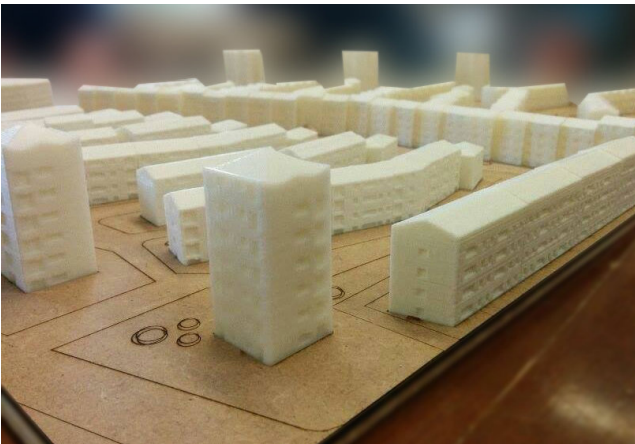
Combinación de técnicas, por un lado tablero de DM con las trazas urbanísticas marcadas por cortadora láser y por otro bloques de edificios impresos en 3D
