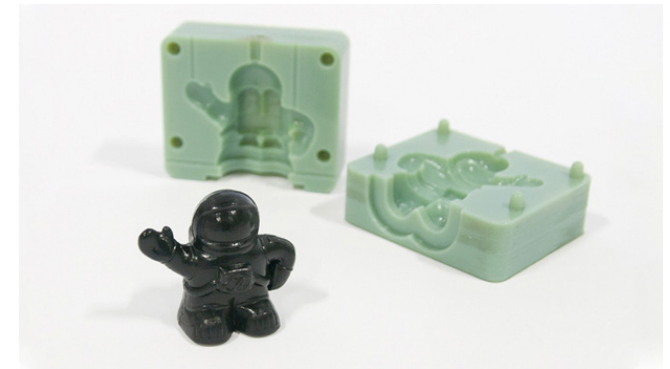
Ejemplo de molde constituido por impresión 3d para simplificar el proceso de creación de la pieza
