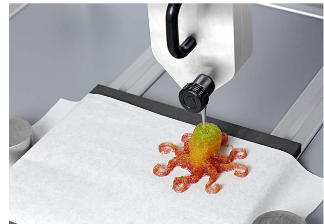
Ejemplo de impresión 3d alimenticia con la primera impresora de gominolas del mundo "Magic Candy Factory"
