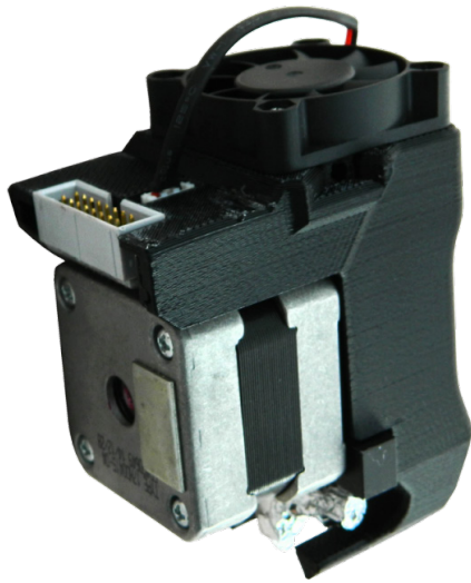
Cabezal de extrusión de la impresora con la resistencia térmica, el motor de toma de filamento y ventilador para la regulación de la temperatura incorporado.
