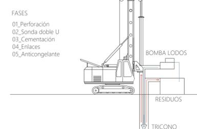
Los enlaces de las sondas geotérmicas al edificio van electrosoldados y realizados en tubería de 40mm. Con una pieza "Y" juntamos dos tubos de 32mm a un tubo de 40mm. Así entramos en la sala de calderas con solo dos tubos de 40mm por cada sonda. Para su protección contra heladas enterramos la tubería a una profundidad mínima de 60cm.
