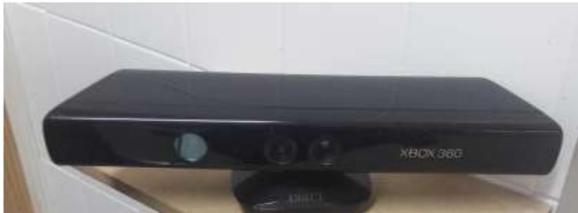
*Figura 2: Sensor kinect*
