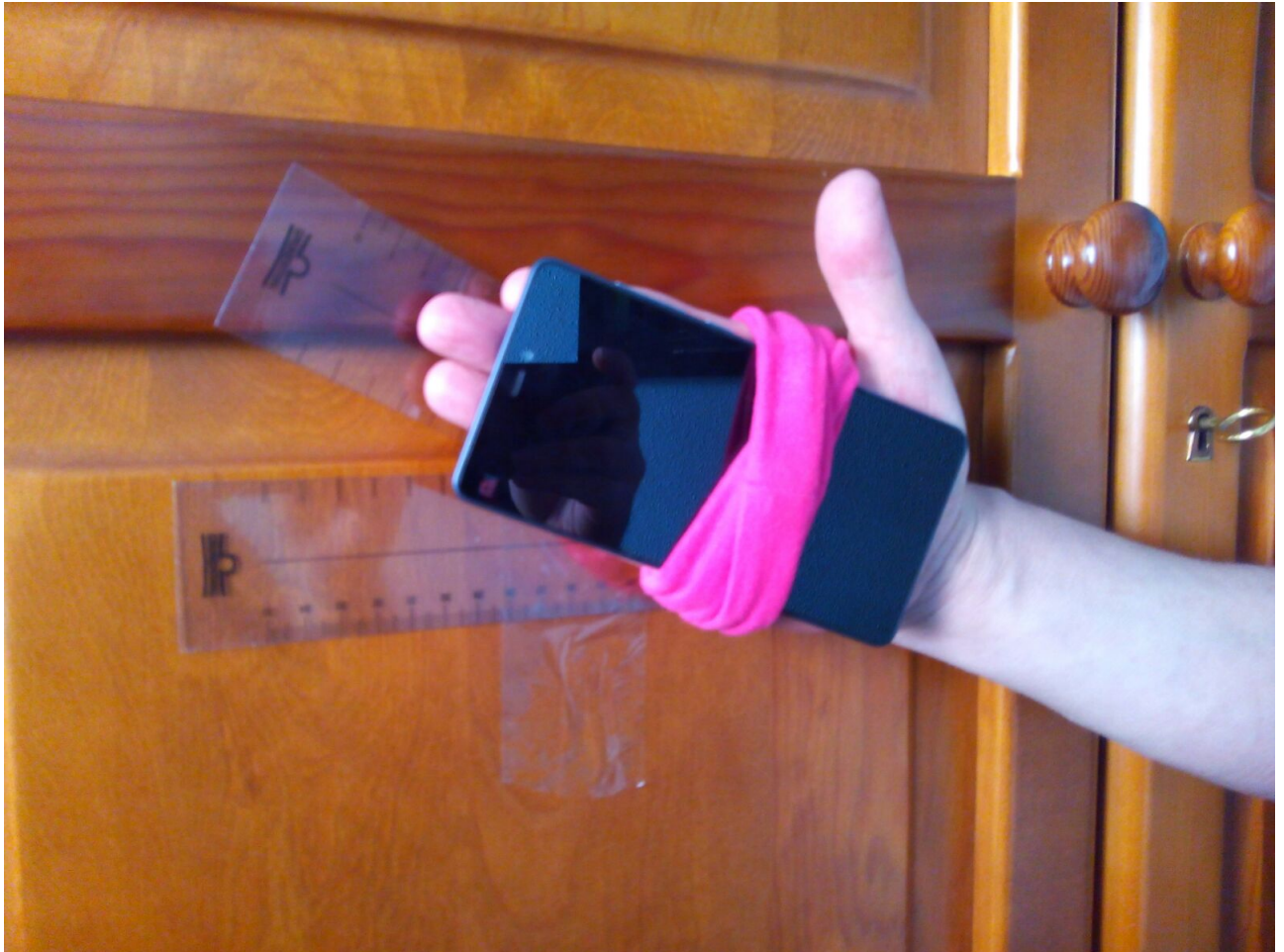
Figura 66: Procedimiento para pruebas del ángulo pitch
