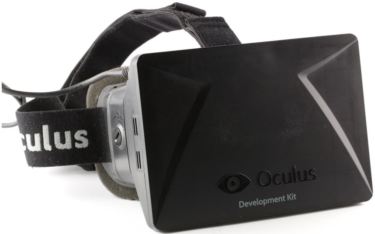
Figura 3: Primer dispositivo desarrollado por Oculus Rift conocido como DK1
