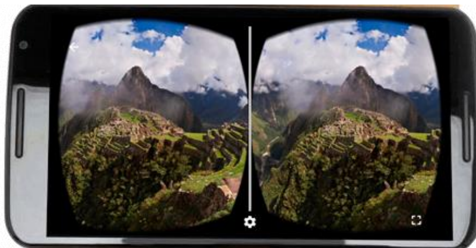
Figura 5: Dispositivo móvil ejecutando una aplicación en vista estereoscópica
