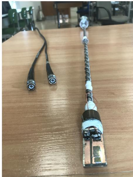
Figura 4.8: Conexión de las muestras al vástago del criostato
