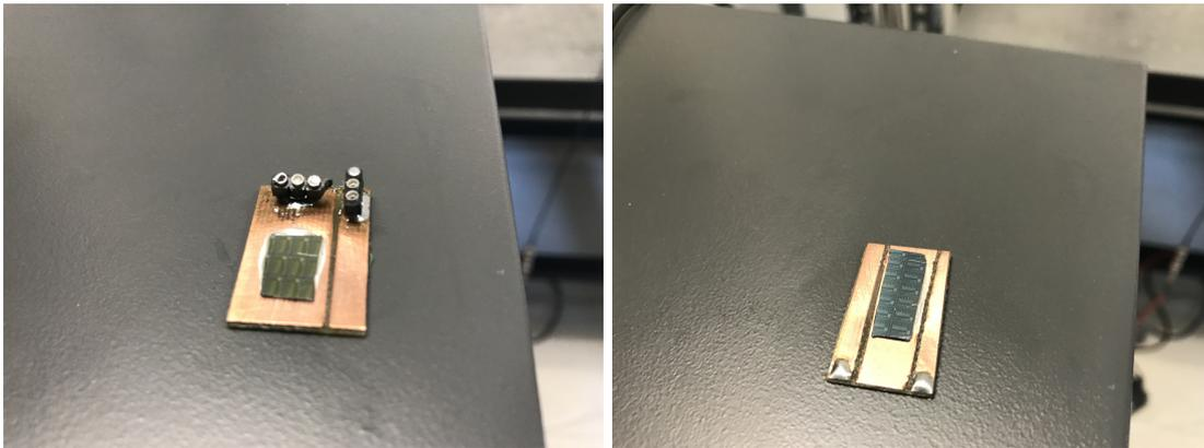
(a) Muestra MIS preparada sobre la placa cobre (b) Muestra MIM preparada sobre la placa cobre
