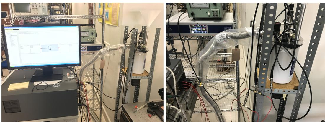
(a) Conexión entre el criostato y el equipo Keithley para medidas I-V
