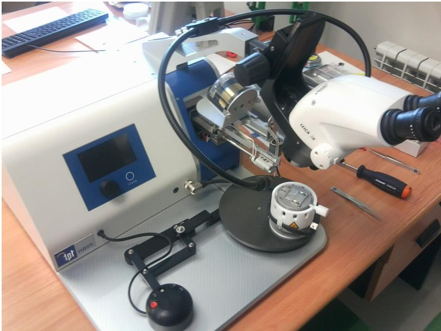
Figura 2.10: Equipo de wire-bonding tpt HB05
