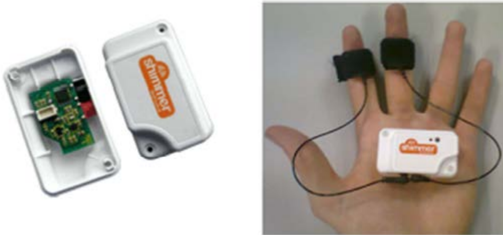
Figura 14. Módulo GSR y colocación.
