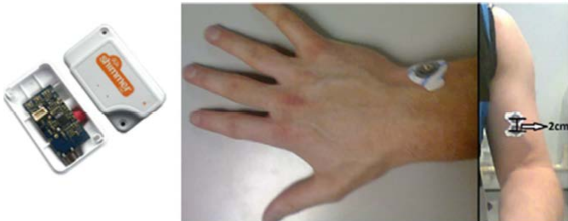
Figura 15. Módulo EMG y su colocación.
