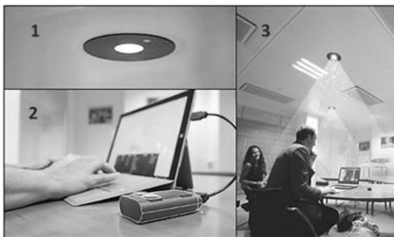
Una lámpara LED con LiFi integrado (1) y un dongle LiFi conectado al dispositivo (2) crean un sistema LiFi completo (3)
