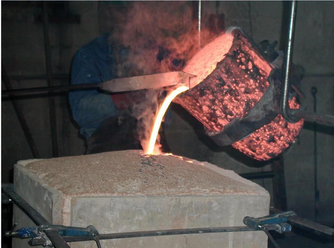
Fig. 1 - Llenado de un molde. Colada de acero. [Unimold]
