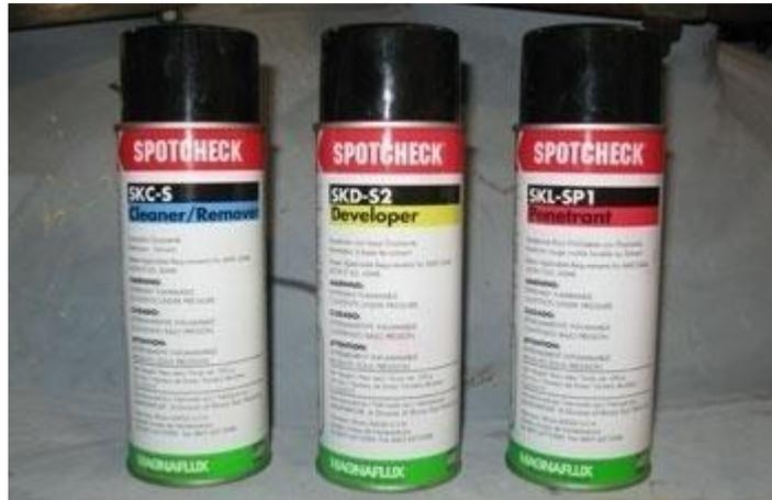
Fig. 51 - 3 productos que se deben aplicar para realizar el ensayo
