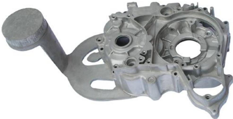
Fig. 6 - Pieza desmoldeada con bebederos [Undo prototipos]
