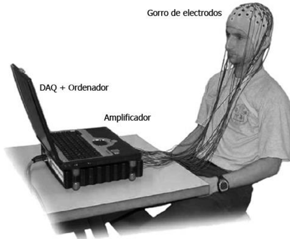
Figura 1-6. Sistema BCI basado en EEG. La señal es captada mediante electrodos colocados en el gorro, y mediante los cables se transmiten hasta el amplificador. Este dispositivo la amplifica y acondiciona para convertirla al dominio digital y la transmite al ordenador, donde se realiza el procesado [6].
