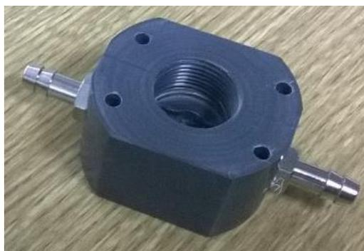
Figura 3. 9: Sensor de presión de la entrada (izq.) y su pieza de acople (der.)
