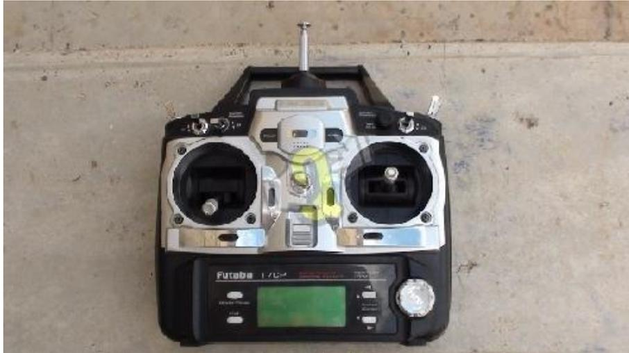
**Figura 27. Emisora Futaba FF7 t7cap a 35 MHz con la que se controla el desplazamiento del perfilador acústico dentro del cauce desde la orilla.**
