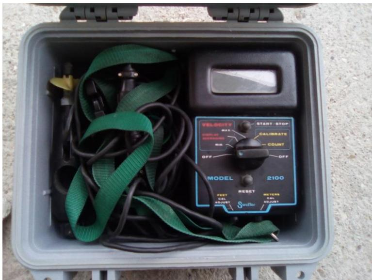
**Figura 25. Molinete hidráulico Swoffer Model 2100 utilizado para realizar las medidas de velocidad del caudal que circula por cada tramo de estudio.**
