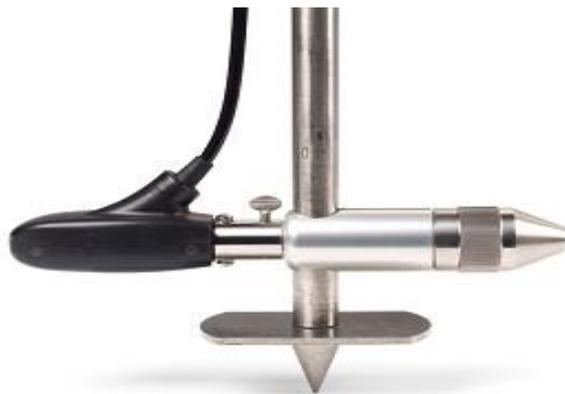
**Figura 5. Molinete electromagnético.**
