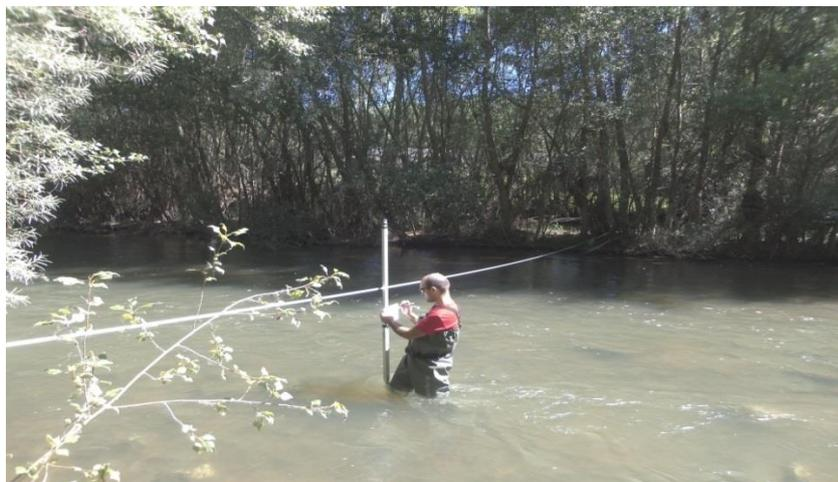
Figura 17. Levantamiento de la sección batimetría en el tramo 1.
