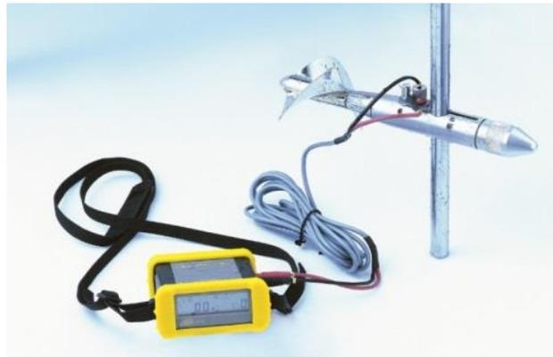
**Figura 4. Molinete mecánico de hélice.**
