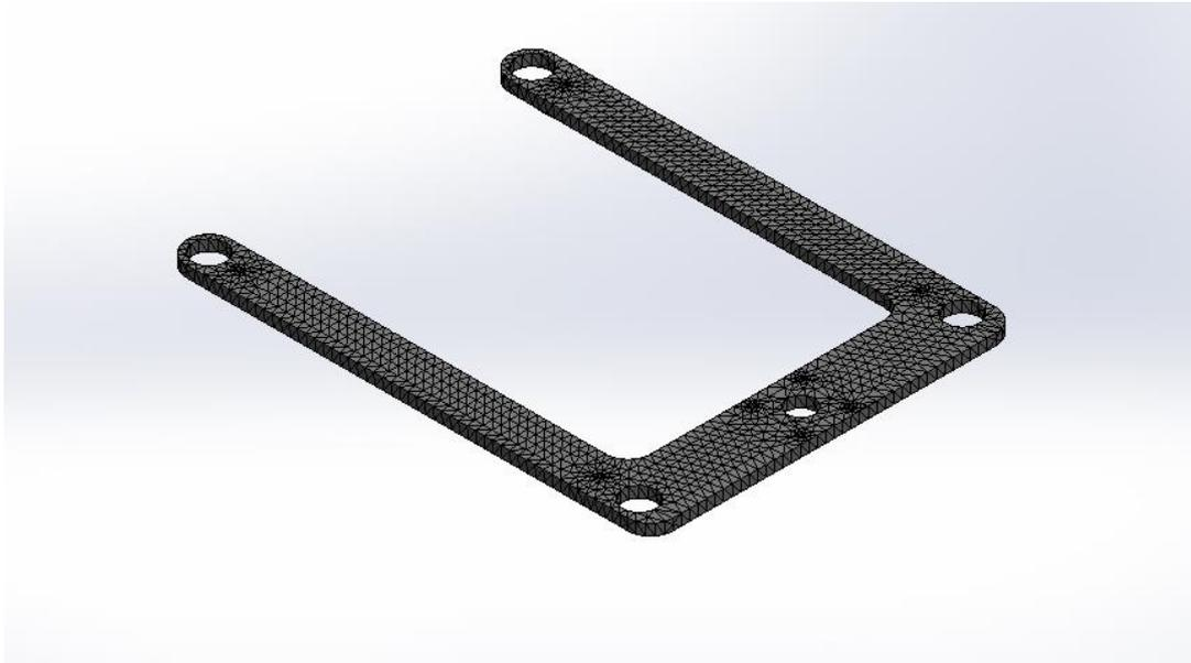
*Fig.123. Malla elementos finitos.*
