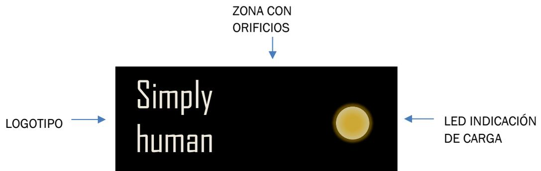
Fig.102. Pieza de plástico para logo, micro y led.
