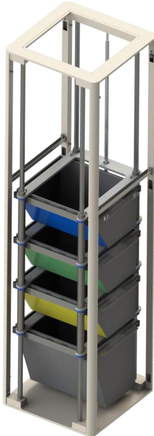
*Fig.73. Estructura, guías, husillo de bolas y conjunto móvil.*
