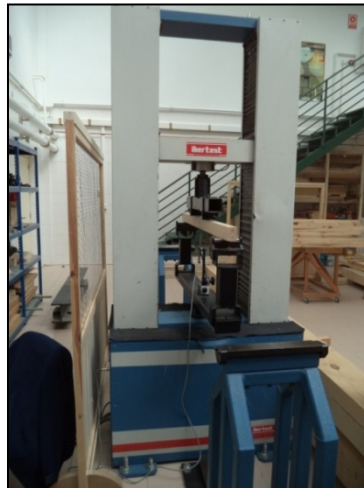
Figura: 24: Vista general de la Máquina Universal de ensayos E.L.I.B.-100 W Ibertest ® utilizada en los ensayos de flexión y de rotura.
