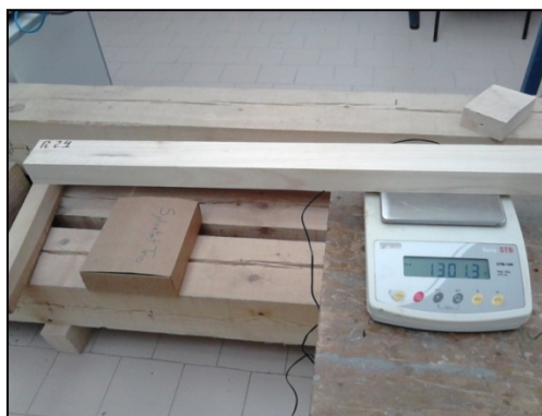
Figura 38: Pesada de una de las probetas. Se pesaron todas las probetas de ambos lotes.
