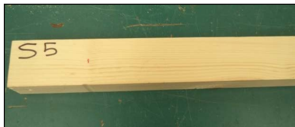
Figura 37: Probeta de Pinus sylvestris L. con su código identificativo formado por una letra y un número.
