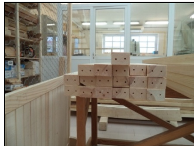
Figura 33: Detalle de los orificios en testas para la realización de la medida directa con equipo de ultrasonidos Sylvatest Trio ® .
