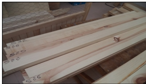
Figura 31: Detalle de probetas pertenecientes al lote de Pinus sylvestris L. identificadas y preparadas para la posterior clasificación visual.
