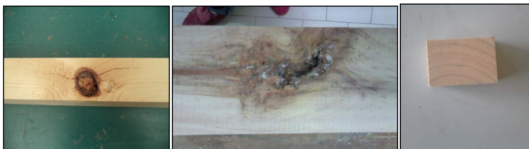
Figura 53: Entrecasco, bolsas de resina y anillos de crecimiento.
