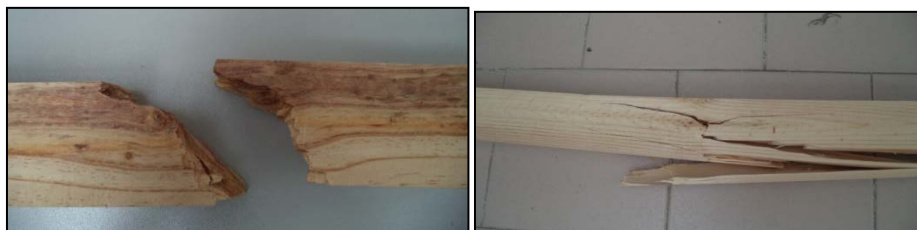
Figura 28: Estado de las probetas después de llevar a cabo el ensayo de rotura. Rotura causada por la presencia de médula en las probetas.
