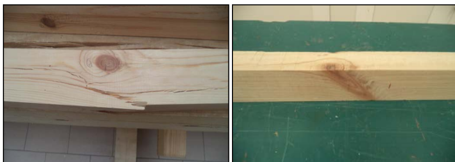
Figura 50: Nudo de margen y nudo de arista.
