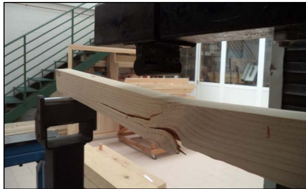
Figura 30: Estado de una de las probetas después de llevar a cabo el ensayo de rotura. Rotura causada por la presencia de desviación de fibra.
