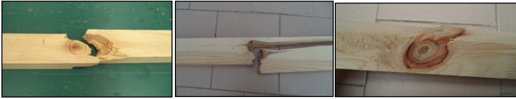
Figura 29: Estado de las probetas después de llevar a cabo el ensayo de rotura. Rotura causada por la presencia de singularidades como nudos.
