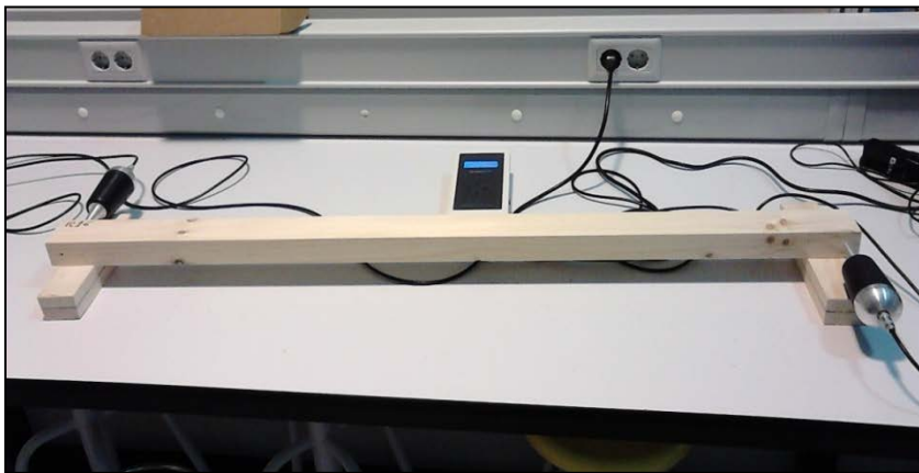
Figura: 17: Toma de medida indirecta con Sylvatest Trio ® en laboratorio.
