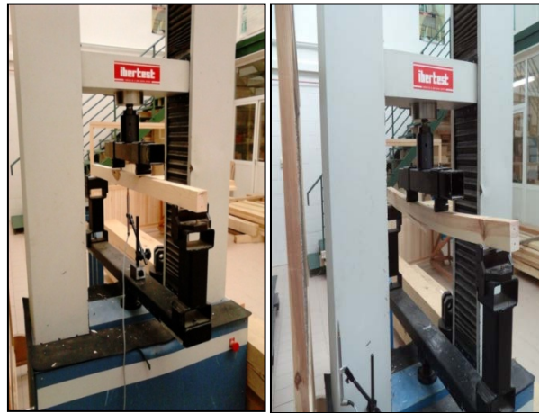
Figura: 26: Extensómetro o sensor de deformación y momento inmediatamente después de la ejecución del ensayo de rotura.
