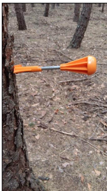
Figura 55. Detalle de la medición de la variable espesor de corteza.
