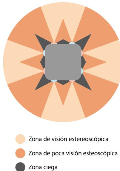
Figura 75. Esquema zonas de visión estereoscópica en una cámara 3D 360°
