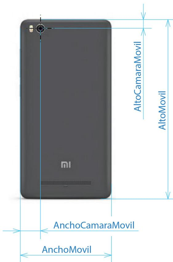
Figura 91. Medidas necesarias del soporte para smartphone
