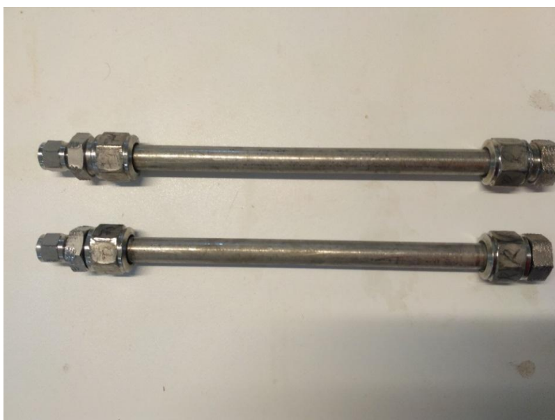
Figura 10 Reactores de inconel aleación 625 utilizados en la reducción de compuestos de Zn. Fuente propia.
