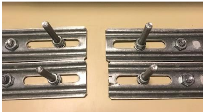
Figura 49. Perfiles ranurados sobre los que se sujeta el motor.
