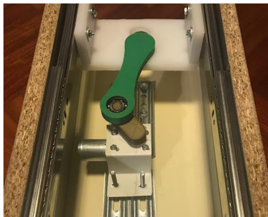
Figura 51. Vista de la disposición del motor y piezas A, B e I del dispositivo.
