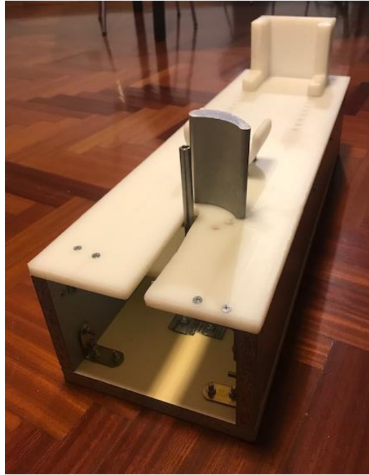
Figura 54. Dispositivo de rehabilitación con todos los componentes montados.
