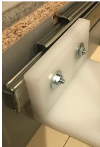
Figura 47. Detalle de la unión entre la pieza I y los carriles prismáticos.
