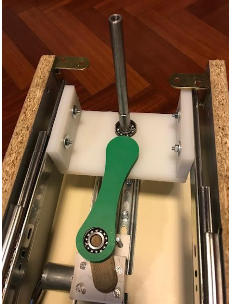
Figura 52. Disposición y montaje de las partes móviles del dispositivo de rehabilitación.
