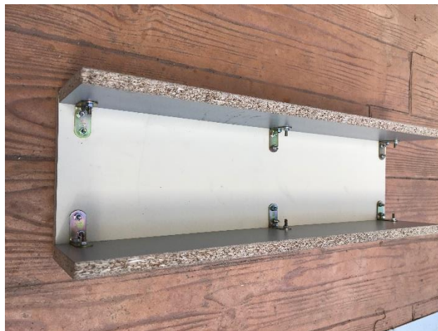
Figura 45. Cajón formado por las piezas Suelo y Paredes.
