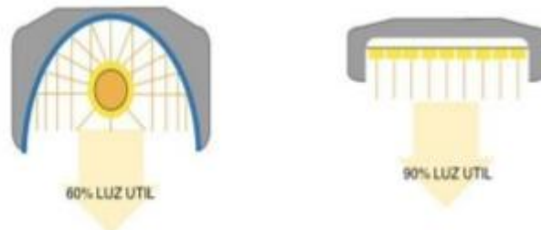
Figura 26. Comparativa del coeficiente de utilización VSAP y LED. Fuente [8]
