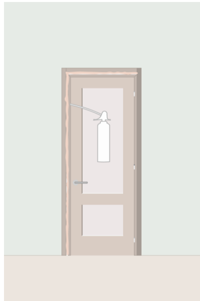
Imagen 59: Sujeción y sellado del precerco.
