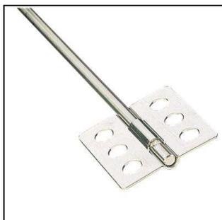
Los agitadores industriales de paletas giran a una velocidad comprendida entre 20 y 150 rpm. La longitud del rodete de un agitador de paletas es del orden de 50 al 80% del diámetro interior del tanque y la anchura de la paleta es de un sexto a un décimo de su longitud.
