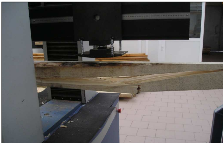
Figura 22: Detalle de rotura de una de las vigas del estudio tras el ensayo de rotura con la máquina universal de ensayos.
