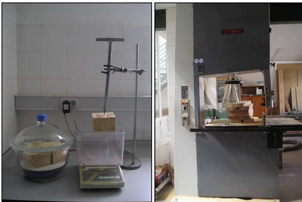
Figura 8: Balanza, desecador, pie de rey, pincho de acero y recipiente (dcha.); Máquina de corte para obtener las probetas de cada viga (izqda.).
