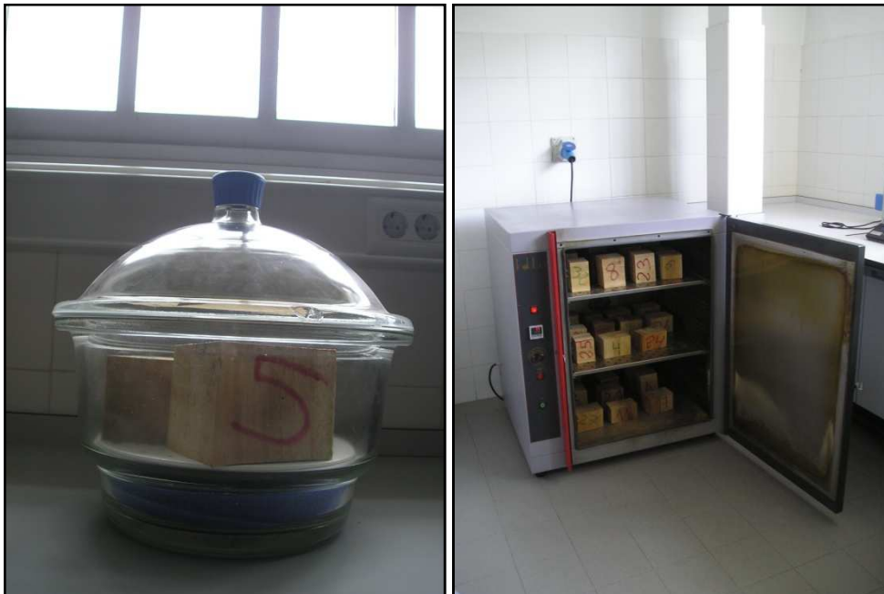
Figura 26: Probetas introducidas en el desecador (dcha.); Probetas introducidas en la estufa para calcular su peso anhidro.
