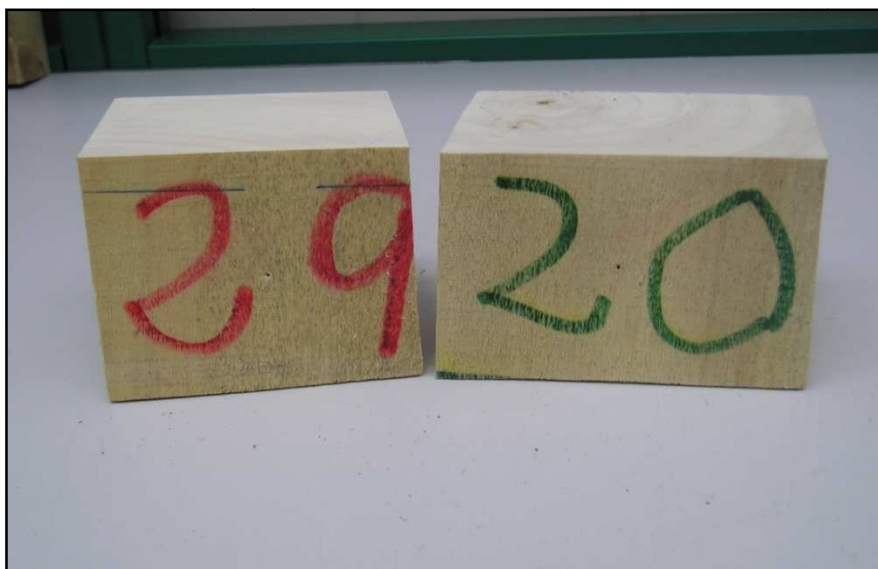
Figura 24: Detalle de alguna de las probetas obtenidas de las vigas del estudio.
