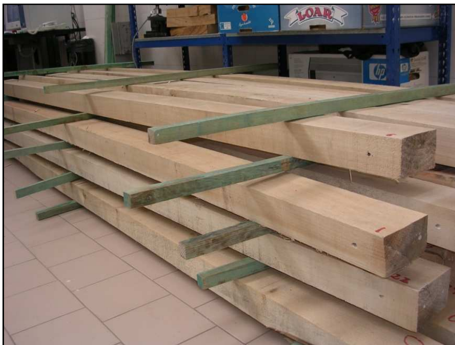
Figura 6: Lote de vigas de Populus x euramericana I-214 analizado el en presente trabajo.
