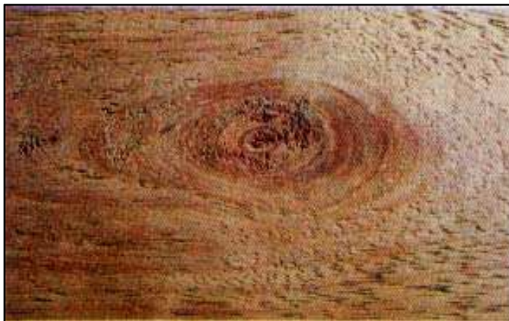
Figura 1: Ejemplo de nudo en una viga de madera (Fuente: elab. propia).
