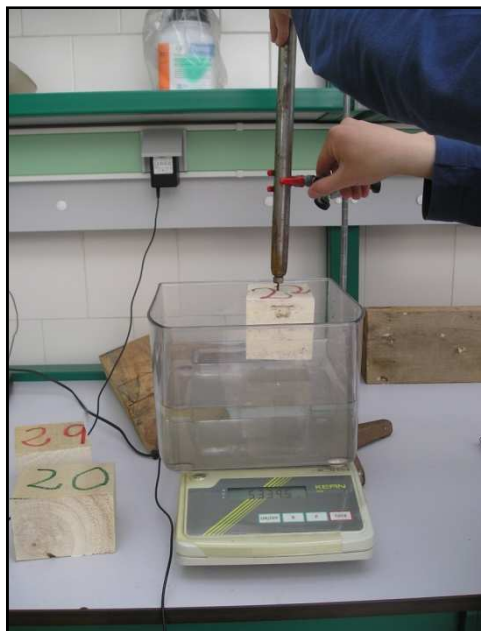
Figura 25: Medición del volumen de las probetas por el principio de Arquímedes.
