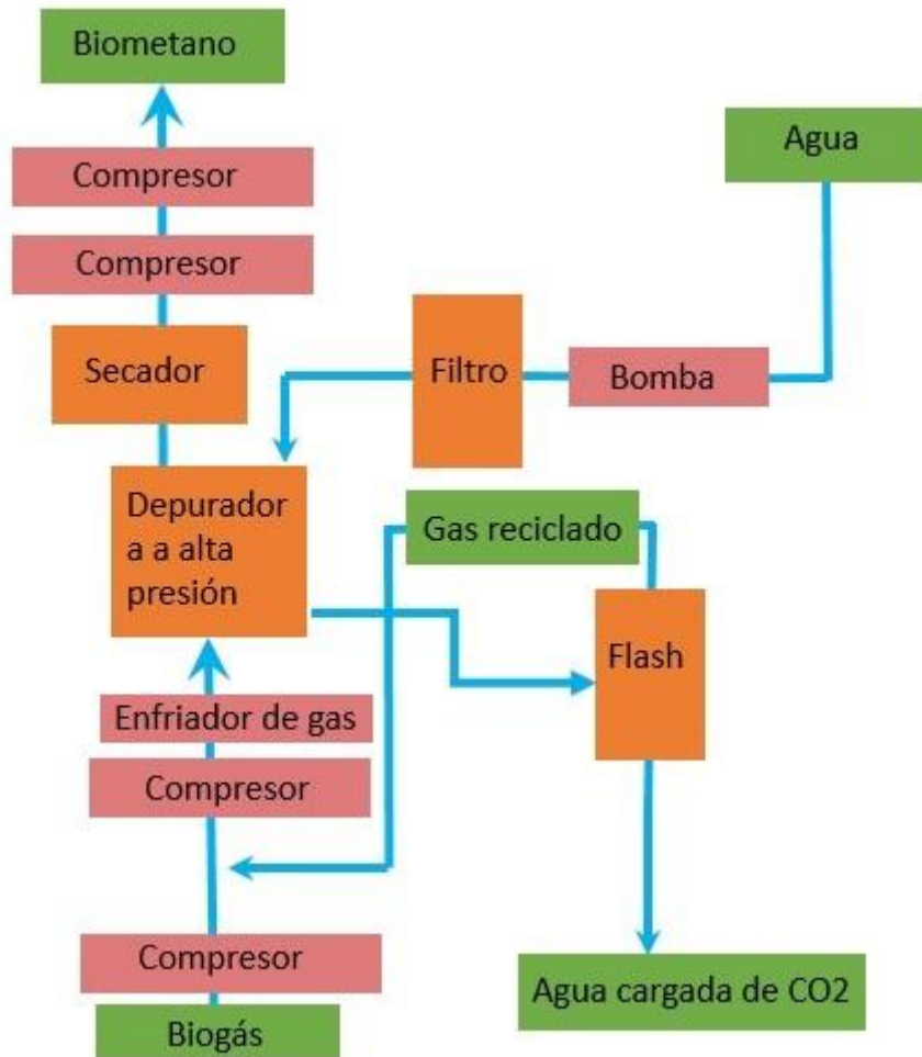
Figura 11. Configuración C para planta HPWS adaptada de [9]
