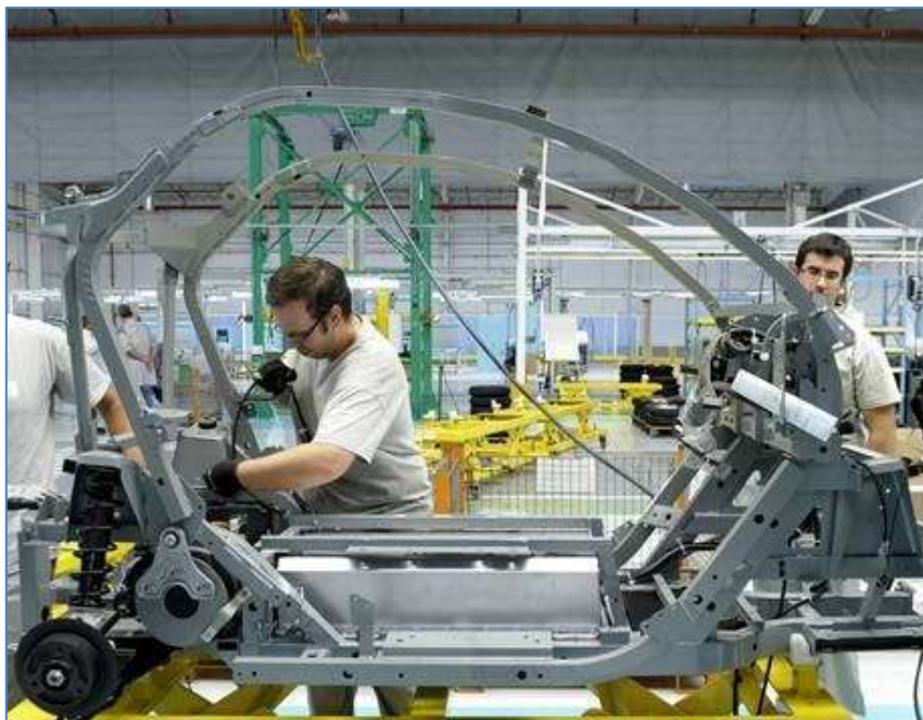
Fig. 5. Chasis tubular de perfil cuadrangular del Renault Twizy.
