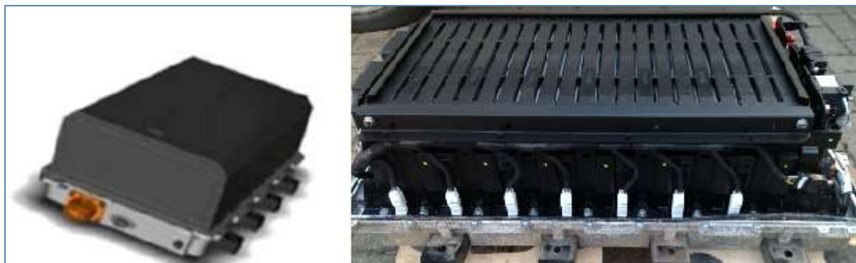
Fig. 8. Batería Renault Twizy, denominación interna BT3.
