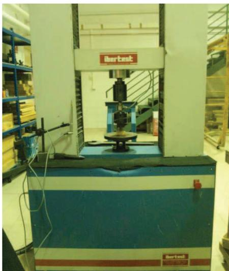
Figura 4.5. Máquina universal de ensayos IBERTEST ELIB-100W
