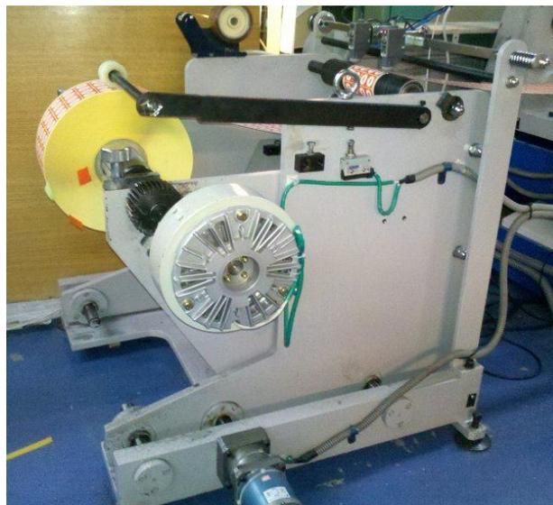
Fotografía 9 – Desbobinador de la nueva máquina
