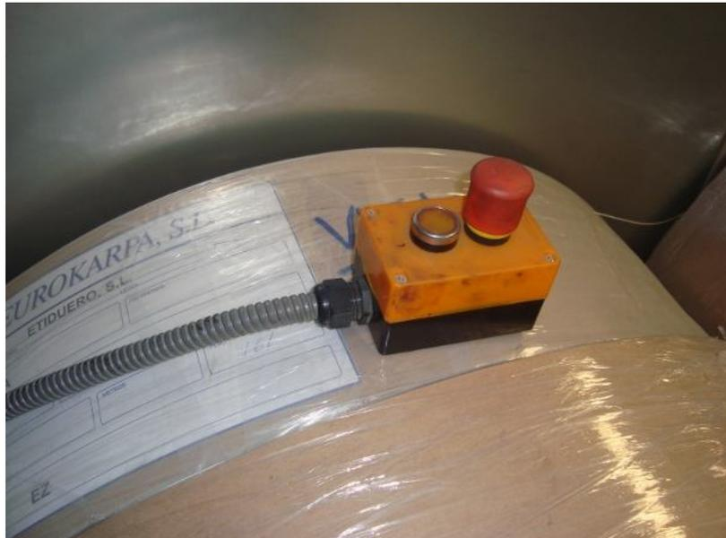
Fotografía 16 - Mando móvil con emergencia y paso a paso
