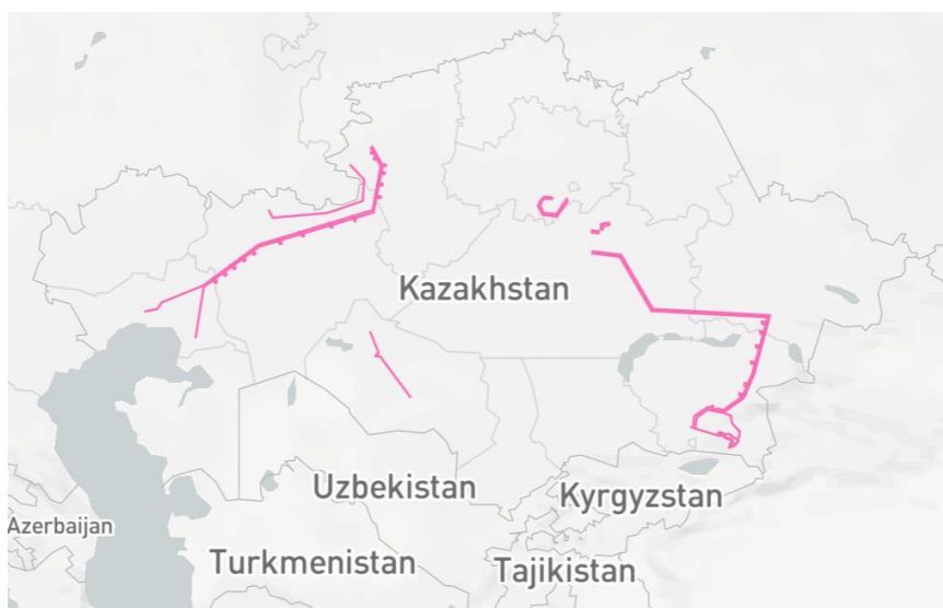
Ilustración 2.4 - Redes de 220, 500 y 1.150kV pendientes de construir en Kazajistán en 2016. (Energydata.info, s.f.)
