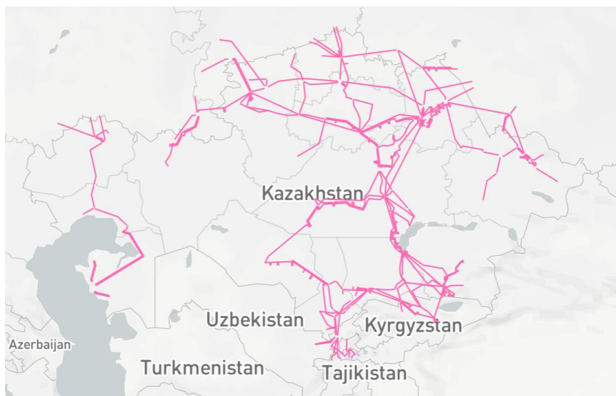
Ilustración 2.3 - Redes de 220, 500 y 1.150kV existentes en Kazajistán en 2016. (Energydata.info, s.f.)
