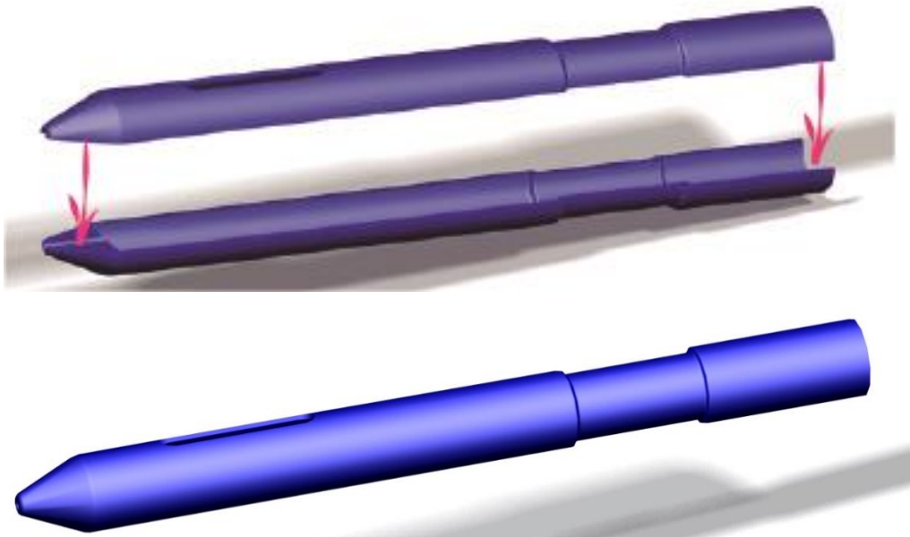
Ilustración 181-Seceuncia de montaje del cuerpo del lapicero
