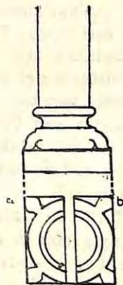
Fig. 1.<sup>a</sup>—Bases de las columnas de la torre.
