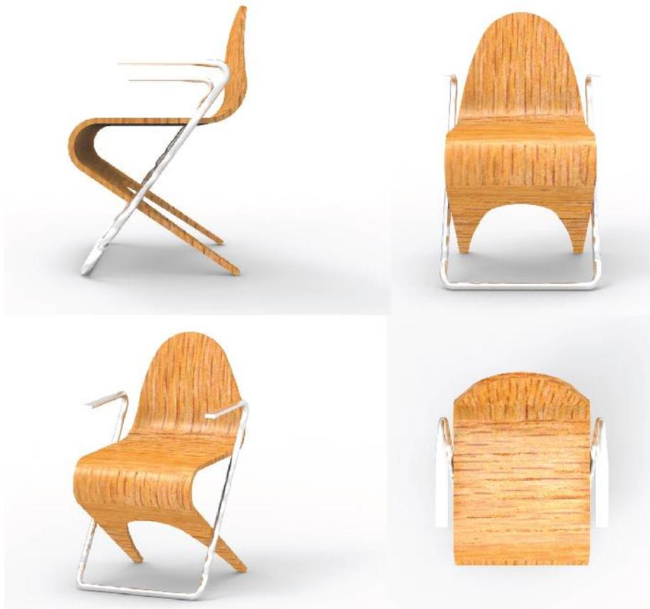
Sin embargo, después de hacer los cálculos, se verifica que con esta silueta de recorte no se consigue el objetivo pues no encajan lo suficientemente bien como para caber dos sillas en el largo del tablero.
