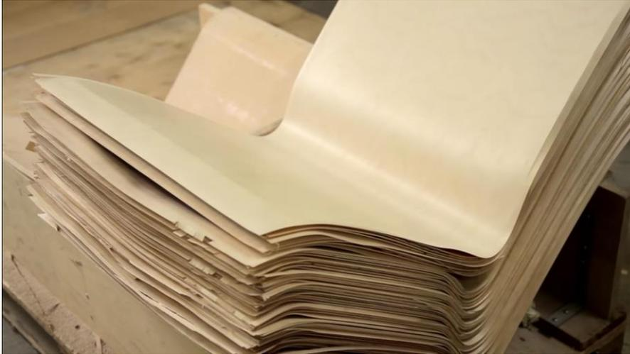
Un tablero normal de contrachapado de más de 6 mm de grosor es imposible de plegar (se fractura), pues las láminas encoladas de madera están colocadas alternando las direcciones de sus fibras, además que esa cola no se funde con el calor. Un tablero de menos de 6 mm de grosor, resulta tremendamente costoso y difícil de conseguir un buen acabado y una curva suave.
