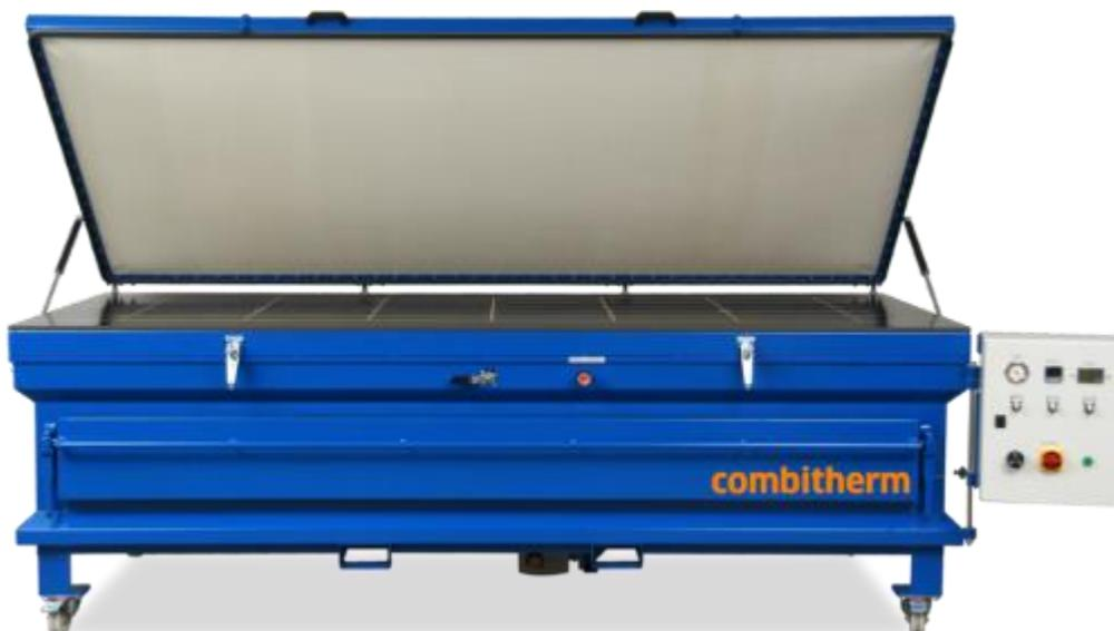
Continuando con la fabricación de la pieza de madera de la Tiket 6, una vez está el contrachapado y el molde preparado, el proceso es sencillo. Tras calentar el panel de UPM Grada 2000 a más de  $95^{\circ}\text{C}$ , el adhesivo entre las capas se funde, permitiendo el deslizamiento de las chapas para darles la forma.
