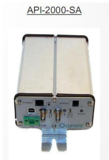
Figura 36. Equipo de inyección PLC.
