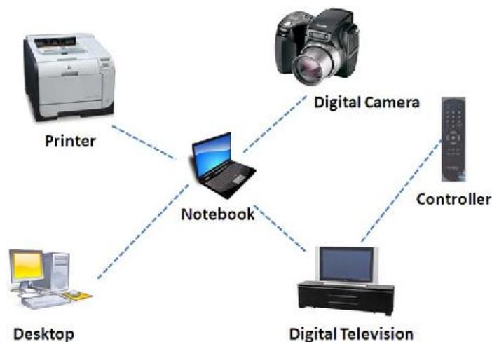
Figura 8. Ejemplo de algunos dispositivos unidos mediante una red WPAN.
