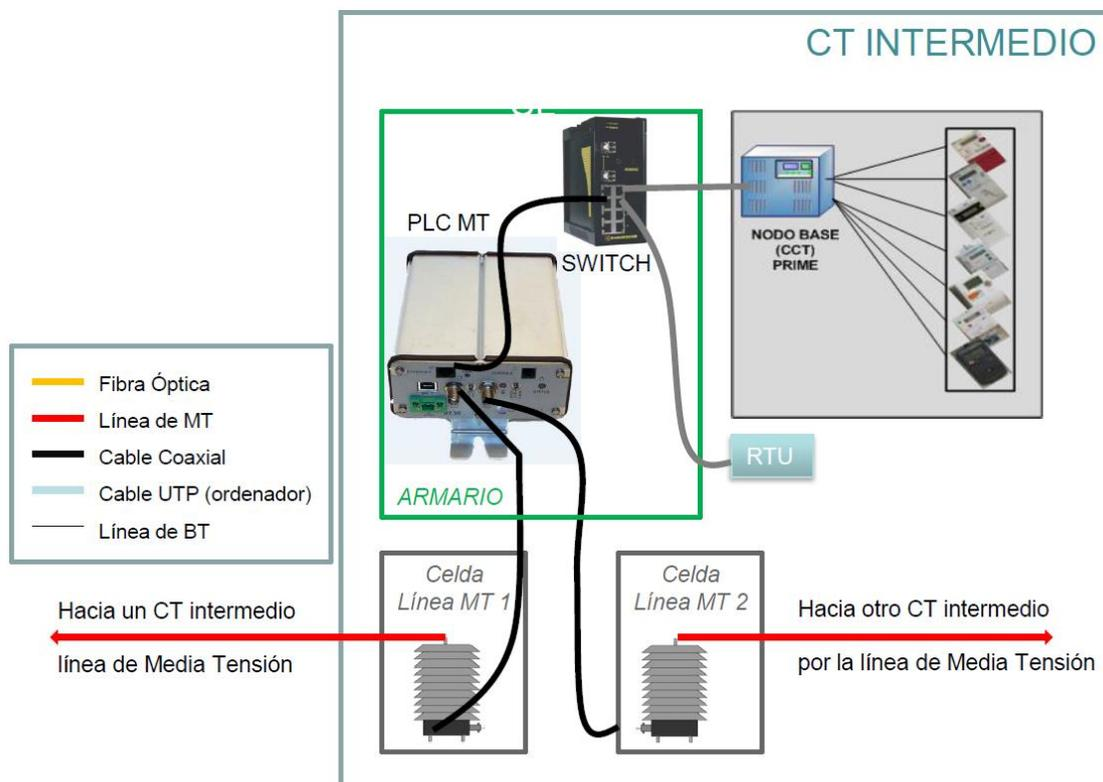
Figura 29. Ejemplo de un CT intermedio.
