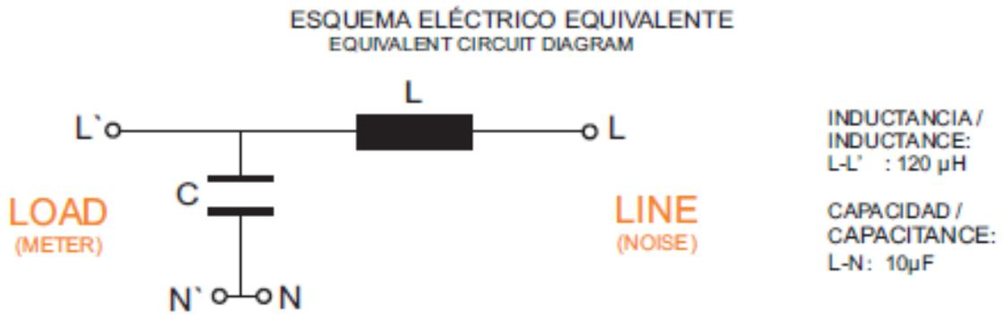
Figura 86. Esquema eléctrico del filtro F.
