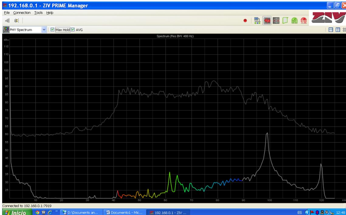
Figura 90. Gráfica obtenida utilizando el filtro F conectando el neutro.
