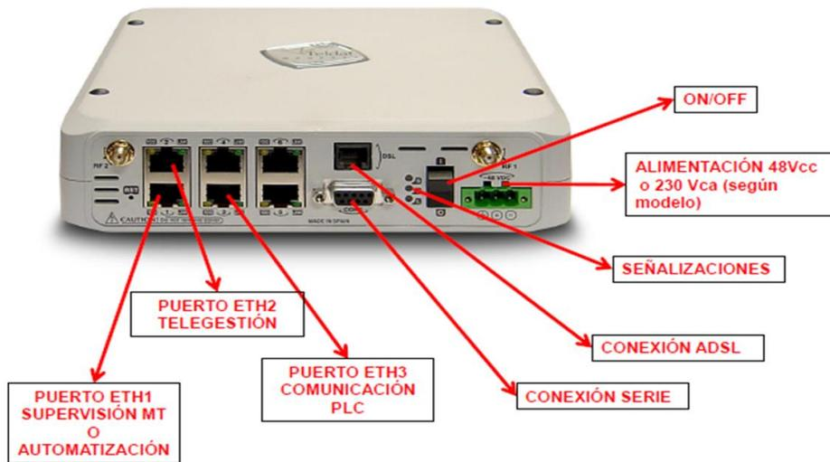
Figura 35. Funcionalidades de un router GPRS.
