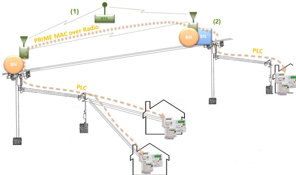
Figura 31. Ejemplo de comunicación entre nodos base de diferentes subredes.
