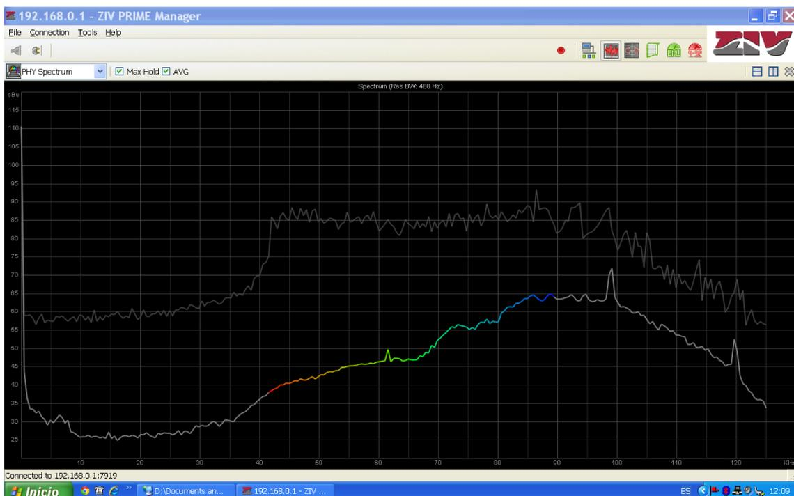
Figura 65. Gráfica del ruido en la red de BT una vez conectada la fuente que genera el ruido.
