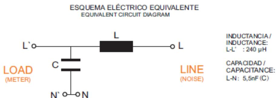
Figura 81. Esquema eléctrico del filtro E.
