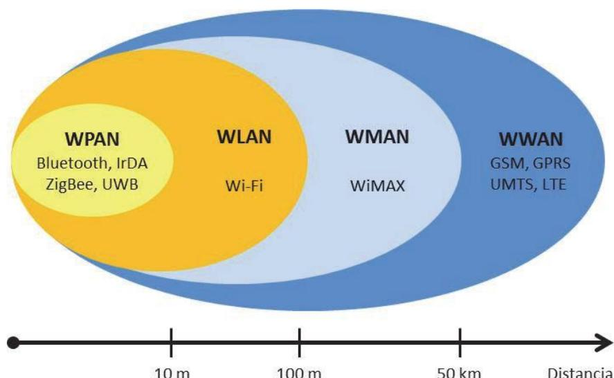
Figura 7. Clasificación de las redes inalámbricas según su alcance y capacidad.
