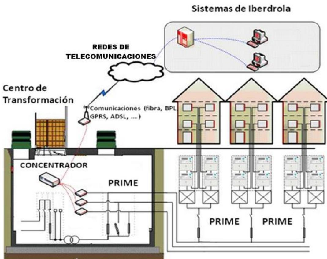
Figura 20. Distintos elementos de comunicaciones dentro de la red STAR.
