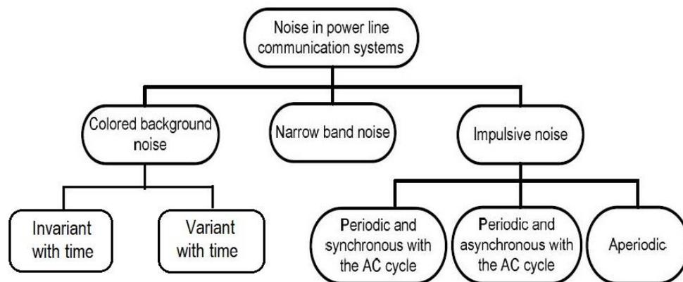
Figura 45. Clasificación de las distintas fuentes de ruido en el canal PLC.
