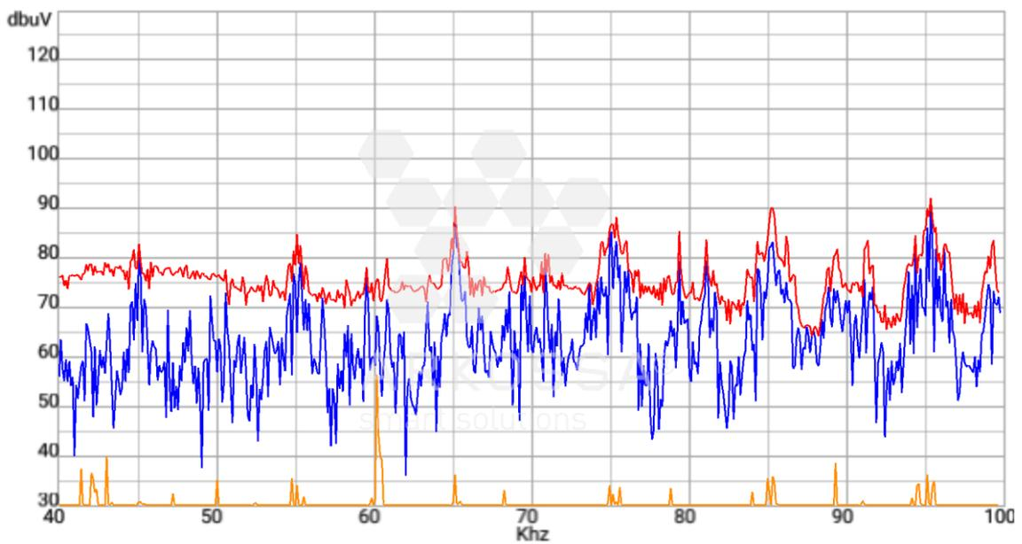
Figura 55. Ruido en la fase R después de filtrar.
