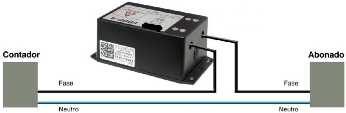
Figura 67. Conexión del filtro A en la red de BT.
