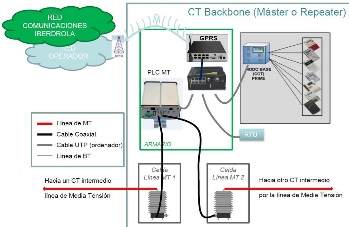
Figura 27. Ejemplo de un CT de cabecera con salida GPRS.
