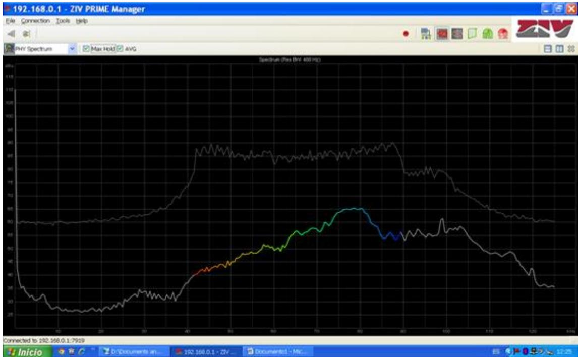
Figura 75. Gráfica obtenida utilizando el filtro C sin conectar el neutro.
