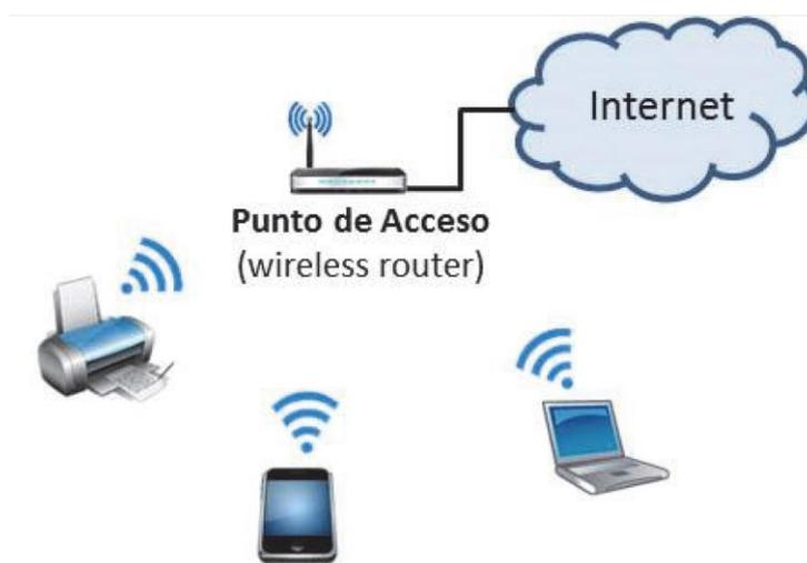
Figura 10. Esquema de una red WLAN.
