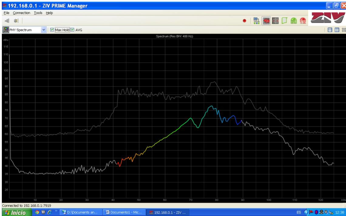
Figura 83. Gráfica obtenida utilizando el filtro E sin conectar el neutro.
