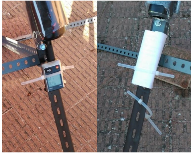
Figura III.3.2. 5 Situación registradores en la entrada de los colectores.
