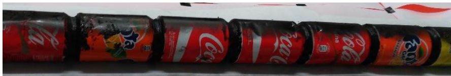
Figura III.1.2. 8 Cordón de silicona del conducto de latas.
