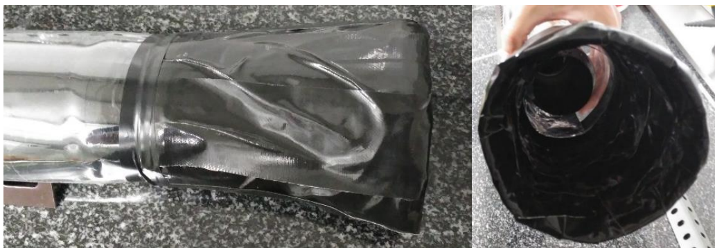
Figura III.1.2. 12 Vista exterior e interior del plénum de salida con cinta aislante.
