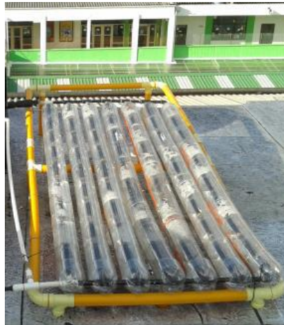
Figura II.3.1. 2 Colector solar térmico de agua con botellas PET [36].
