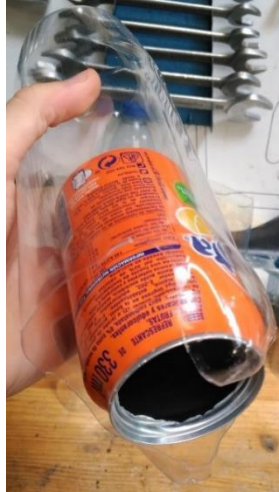
Figura III.1.2. 11 Botella correspondiente con la entrada de aire del colector.
