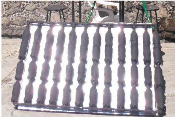
Figura II.3.1. 3 Captador térmico de agua con botellas PET ennegrecidas [37].
