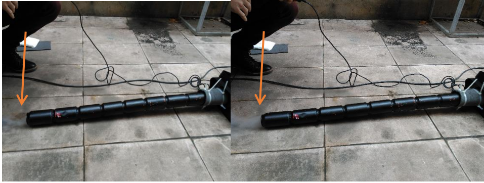
Figura IV.2.1. 7 Prueba fugas internas CGI salida libre.
