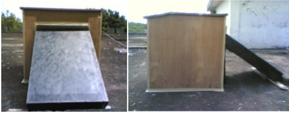
Figura II.3.2. 2 Colector solar de aire con placa metálica [41].
