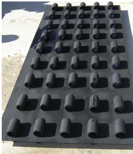
Figura II.3.2. 6 Distribución de latas ennegrecidas en serie en placa absorbidora de un colector solar térmico de aire [43].
