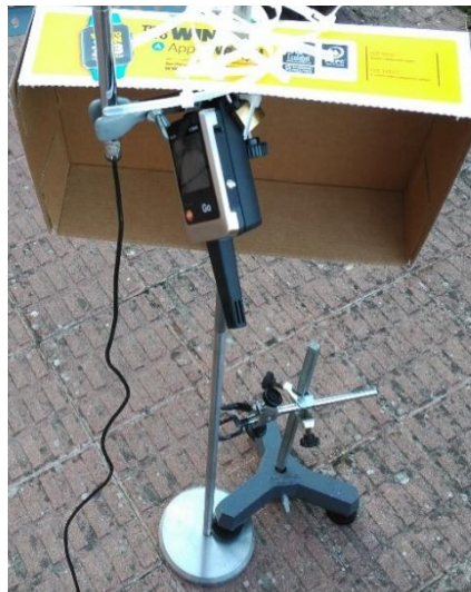
Figura III.3.2. 4 Situación registrador humedad y temperatura ambiente.
