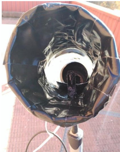
Figura III.3.2. 8 Situación sonda de humedad y temperatura en salida colector.
