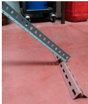
Figura III.1.2. 14 Listones empleados como estructura soporte colectores.
