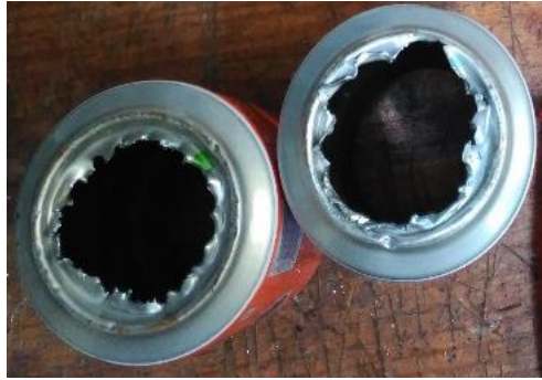
Figura III.1.2. 7 Base inferior lata eliminada con martillo y punzón.
