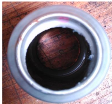
Figura III.1.2. 6 Base inferior lata eliminada con taladro vertical.
