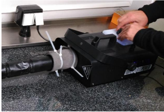
Figura IV.2.1. 2 Ajuste máquina de humo - conducto de latas.
