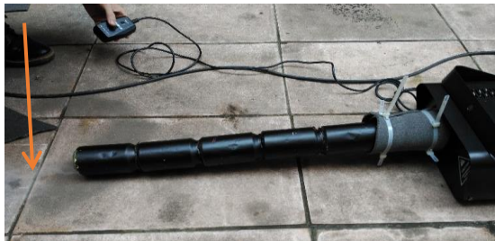
Figura IV.2.1. 9 Prueba fugas internas CPE salida libre.
