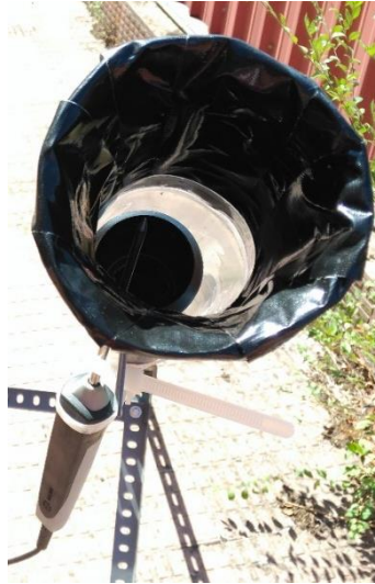
Figura III.3.2. 7 Situación sonda de penetración en salida colector
