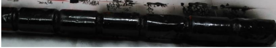
Figura III.1.2. 9 Ennegrecimiento del conducto de latas.
