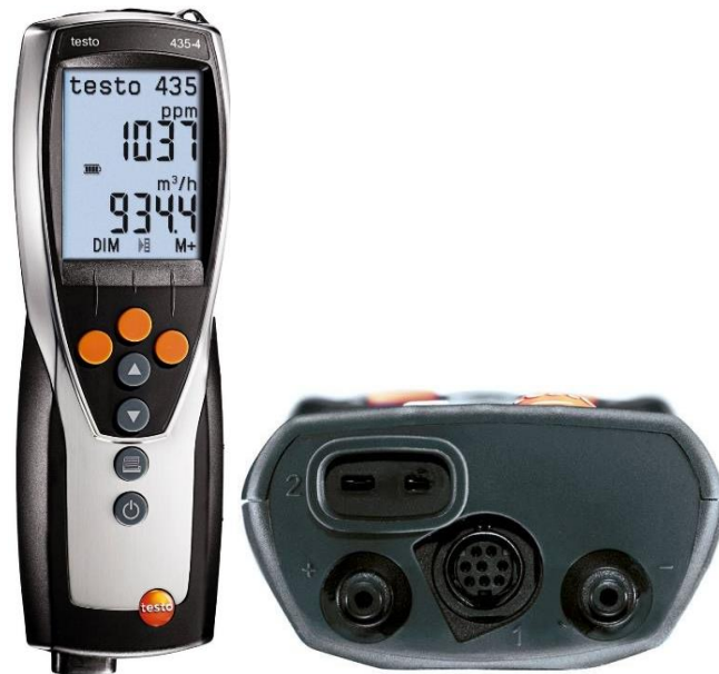
Figura III.3.1. 10 Registrador multifunción con sensor de presión 05634354 [W-24].
