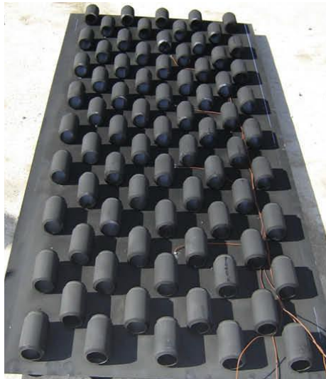
Figura II.3.2. 5 Distribución de latas ennegrecidas intercaladas en placa absorbidora de un colector solar térmico de aire [43].
