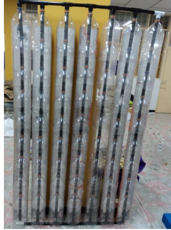
Figura II.3.1. 1 Distribución de botellas PET en un colector solar de agua [36].
