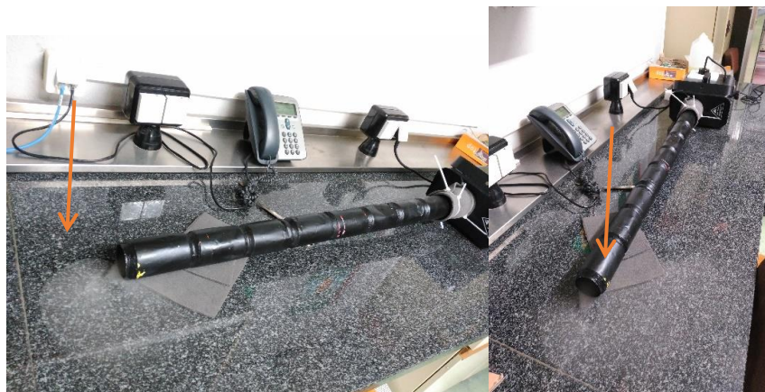
Figura IV.2.1. 3 Prueba fugas internas CGE salida libre.
