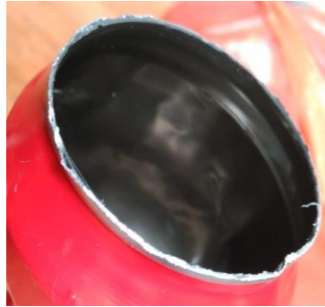
Figura III.1.2. 2 Borde superior lata rallado con lija.
