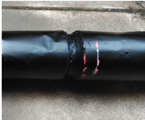
Figura IV.2.1. 11 Roce en el conducto de latas.
