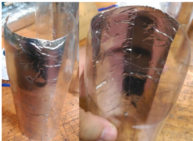
Figura III.1.2. 10 Vista exterior e interior del papel de aluminio en botella PET.
