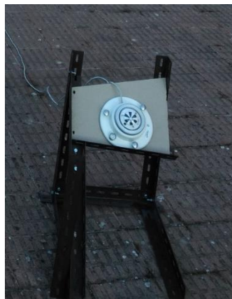
Figura III.3.2. 1 Situación medidor de la radiación solar.
