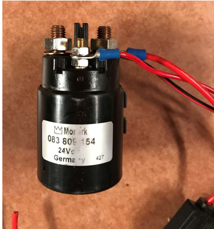
Figura 4.55: Relé para la desconexión de la potencia
