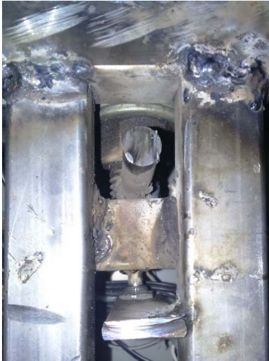
Figura 3.26: Función de tope para manillar
