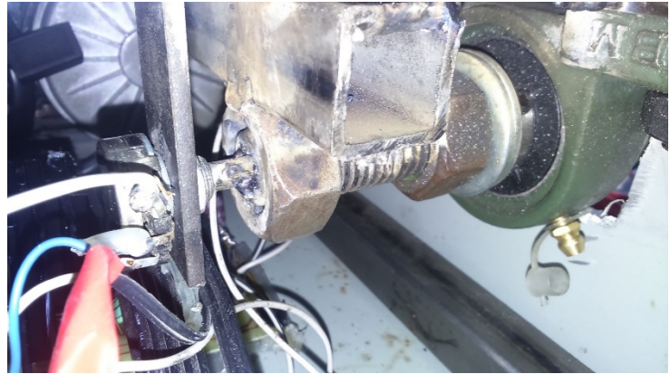
Figura 3.27: Tuerca para evitar que el eje bascule y potenciómetro de medida de giro
