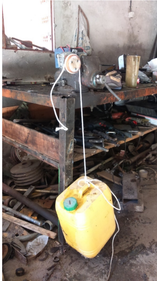
Figura 3.3: Ensayo de bloqueo
