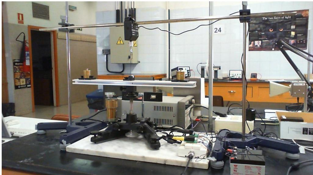
**Figura 4.6.** Equipo completo de medición de la fuerza centrípeta.
