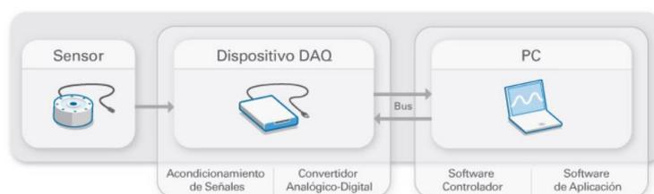
**Figura 5.1.** Configuración general de un sistema PC basado en la adquisición de datos.
