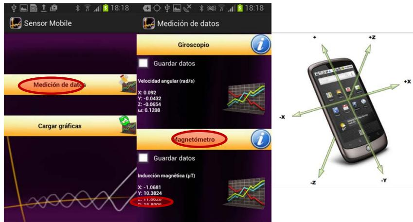
Ilustración 3. SensorMobile. Menú (izq); Datos magnetómetro (centro); dirección ejes (der)
