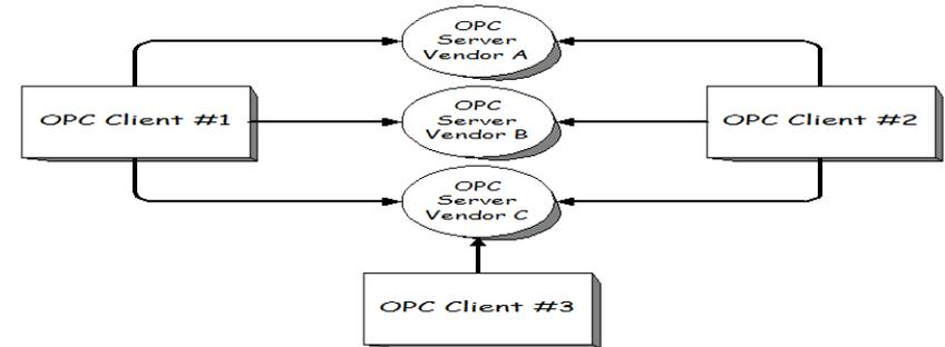
En el caso más elemental el servidor obtiene los datos desde los dispositivos físicos (ej: a través de interface propietaria) o pueden ser datos generados por el propio servidor (un cálculo a partir de medidas físicas) o el servidor a su vez puede ser un cliente de otro servidor OPC, creado jerarquía complejas, que refleja por ejemplo la estructura de la pirámide de ISA-95.
