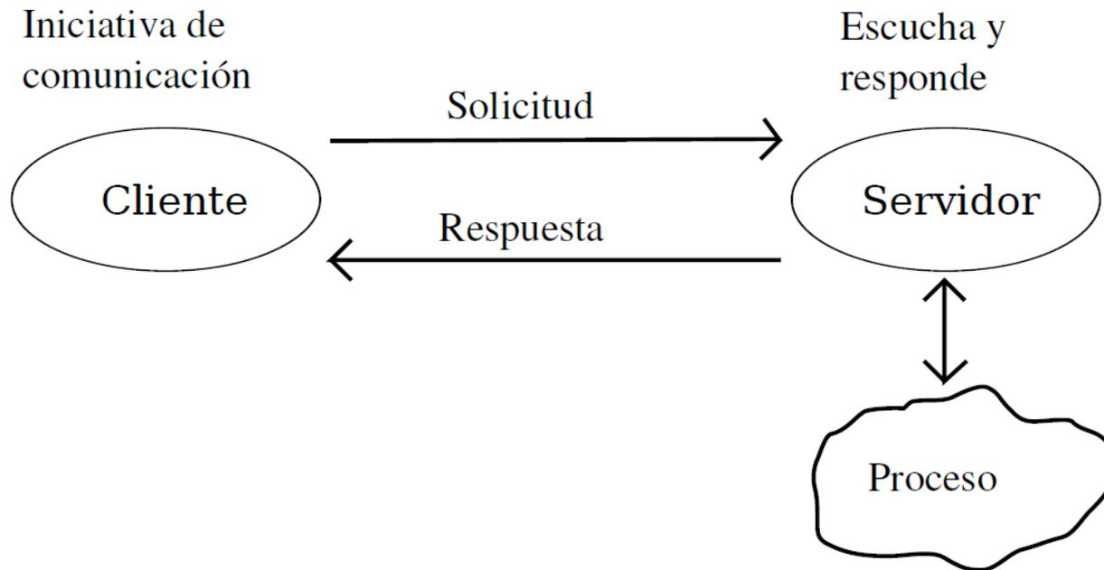
Modelo cliente-servidor, tiene determinadas características generales (compara por ejemplo, con el conocido modelos servidores web/navegadores internet (clientes)):
