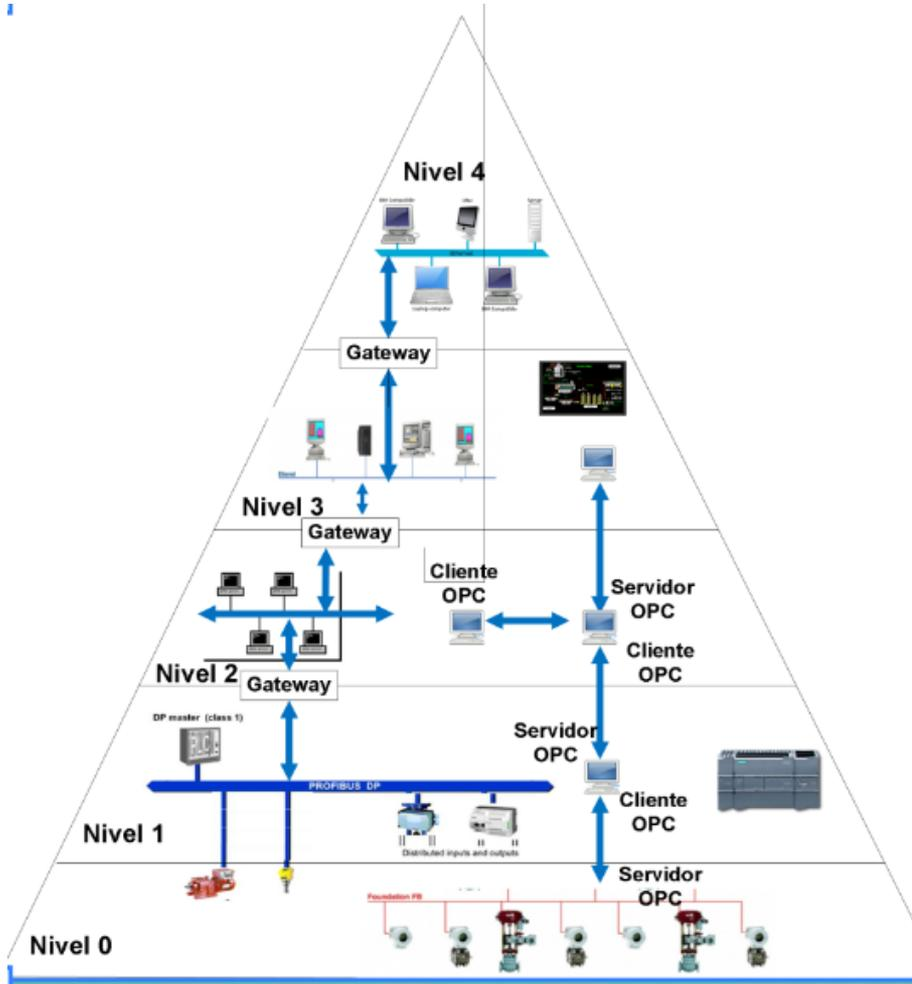
**OPC:** Es un estándar de interoperabilidad para el intercambio confiable y seguro de datos en la industrias Es útil para crear aplicaciones distribuidas en diferentes medios de cómputo conectadas mediante redes informáticas. Las siglas actualmente significan *Open Platform Communications* destacando la actual énfasis en permitir la **interoperabilidad** en plataformas diferentes.
