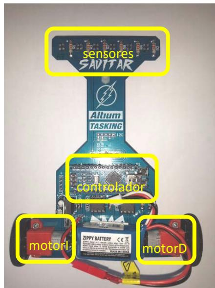
*Figura 2. Estructura del robot siguelíneas*
