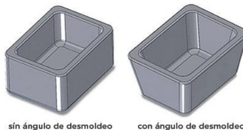
Figura 75- Moldes con ángulos de desmoldeo.
