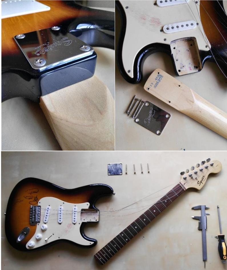
Fig. 51 Desmontaje de la unión mástil-cuerpo de la Fender Squire
