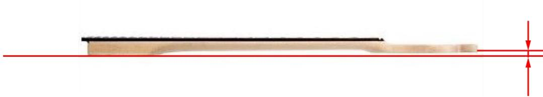
Fig. 82 Base del empotramiento y de la pala a distintas alturas
