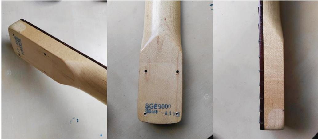
Fig. 80 Detalle constructivo de la unión mástil-cuerpo del modelo Fender Squire
